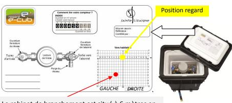
Le robinet de branchement est situé à 6 mètres en amont du regard, décalé de 3 mètres sur la gauche.
